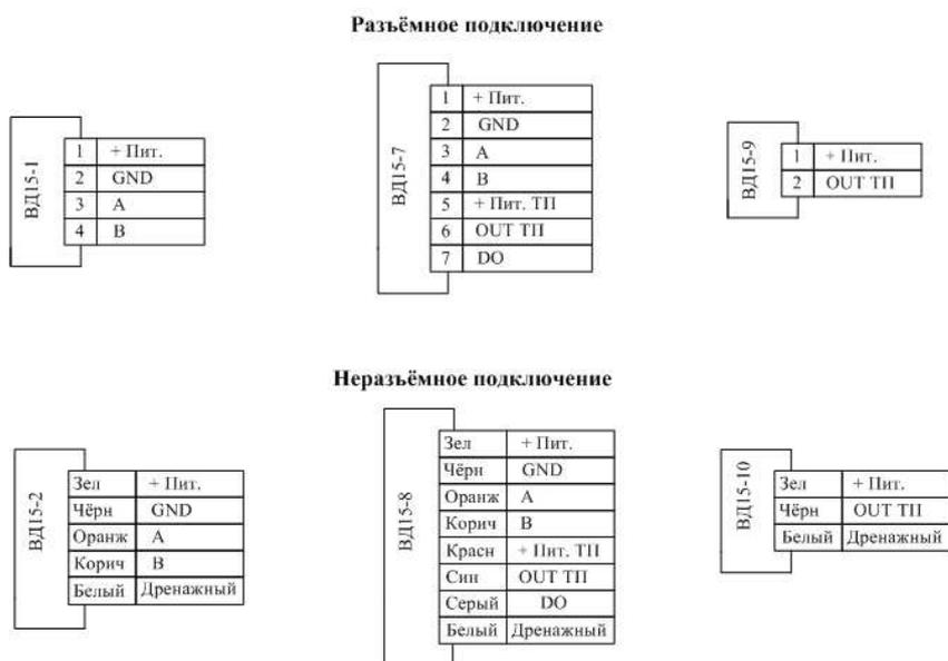
Примечание. Дренажный провод кабеля изолирован от датчика и его корпуса.
