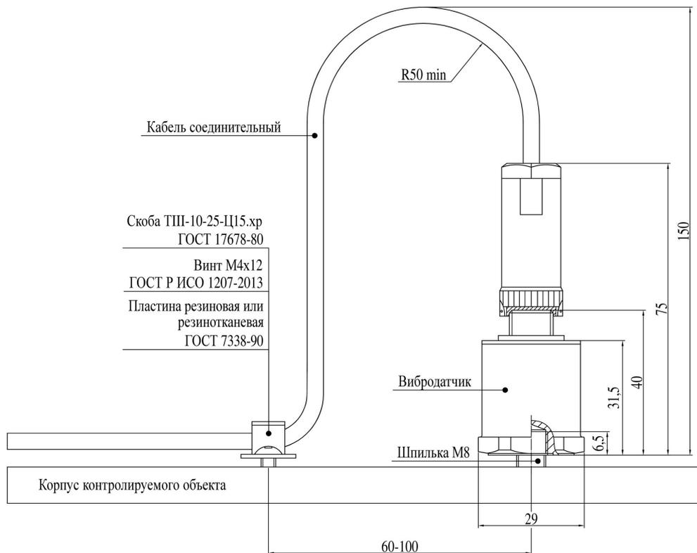
Рисунок 4. Требования к установке датчика на объекте
