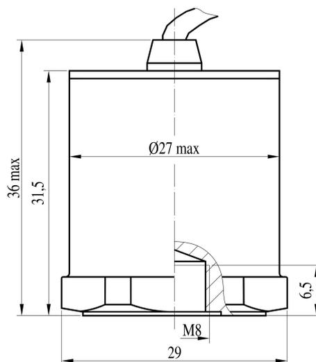
Рисунок 2. Габариты датчика
